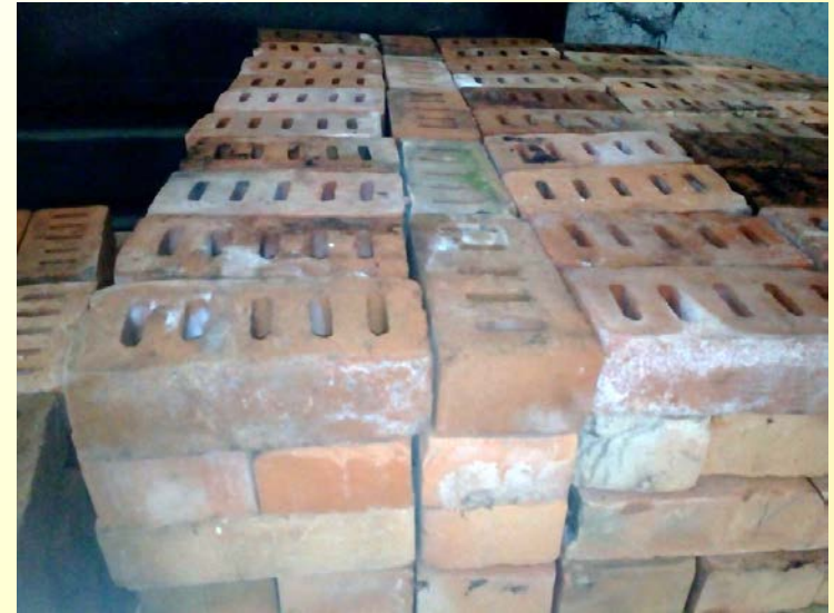
DDR-Ziegelsteine (unbenutzt) mit Salzausblühungen (Quelle: www.kleinanzeigen.de )
