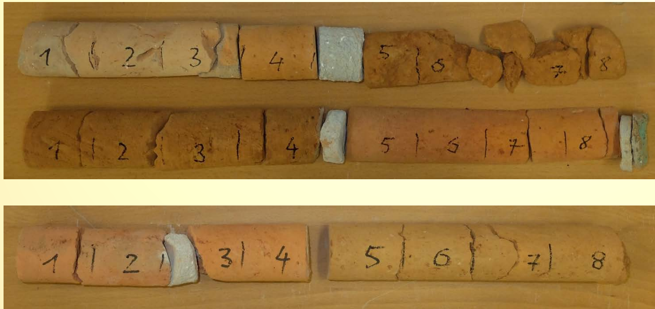
Entnommene Bohrkern mit Ersatzmauerwerk auf der Innenseite
