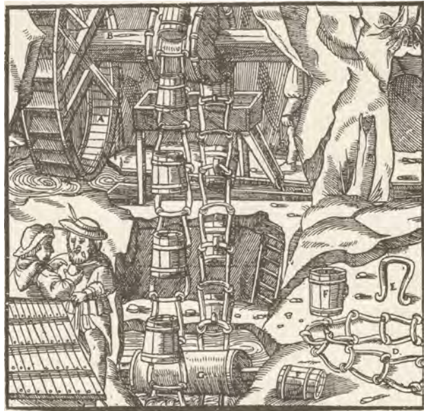
Das Unterschlächtige Wasserrad A. Die Wälle B. Die Trommel, auf der Klammern eingehängt sind C. Die Kette D. Ein Kettenglied E. Die Kannen F. Die untere Trommel G.
